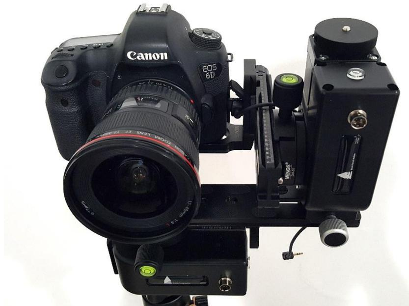
Alternativ können Sie den L-Winkel auch ohne die zusätzliche Arca Schiene direkt an die Tilt Achse montieren. Beachten Sie jedoch, dass Sie dabei, vor allem bei schweren Objektiven, eine größere Belastung auf die Motor Achse ausüben, und der Motor eventuell Schwierigkeiten haben wird, die Kamera zu bewegen.
